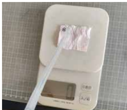
▲水を垂らして吸収させた量による凝固 ペーパーの状態を観察
