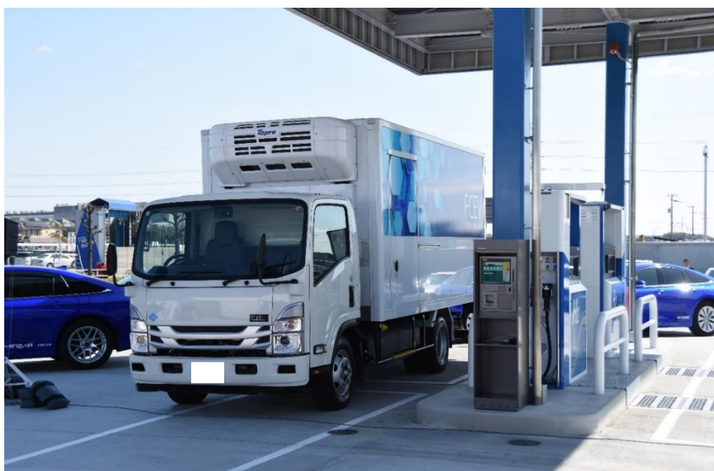
図 73 水素ステーションで充填する燃料電池トラック（とよた堤水素ステーション（市内））
